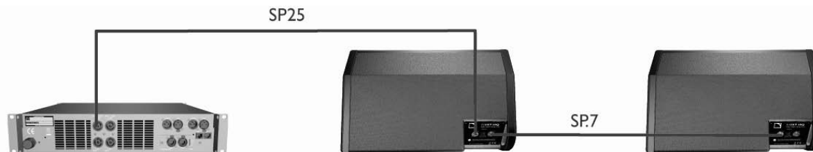
Figure 3 : Raccordement de deux enceintes 115XT HiQ en parallèle au contrôleur amplifié LA4
